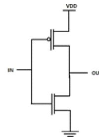
Figure 4 : CMOS Inverter Circuit
