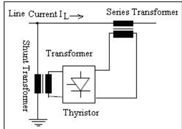
Fig. 5 : Phase Shifting Transformer ( PST )
